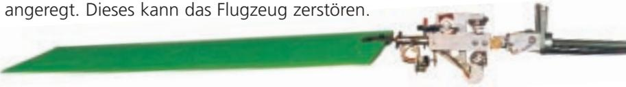
Die Tragfläche des Rundlaufs (oben) ist mit einer Dreh- und einer Schlagfeder ausgestattet, die es ermöglichen, das Flugzeugflattern zu demonstrieren.
