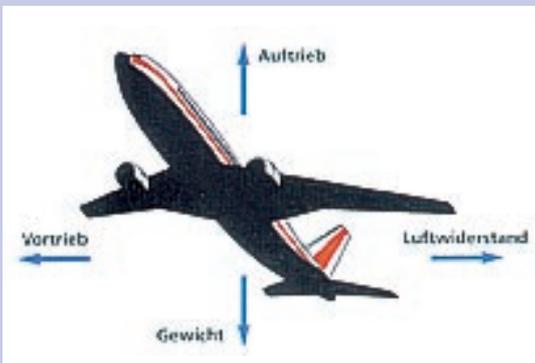
Bild 1: Gleichgewicht der Kräfte beim Flugzeug
