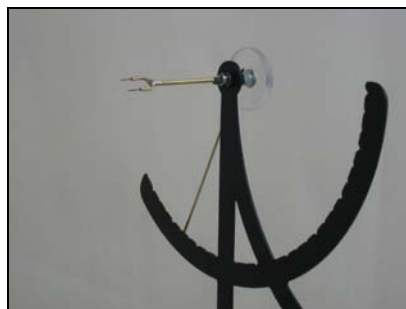
Stellrad für Anstellwinkel mit Winkelanzeige
