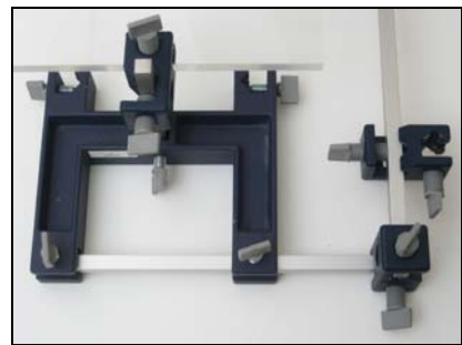
Die L=300mm Stativstange liegt quer im H-Fuß und nimmt das Ende der Experimentierschiene auf.
