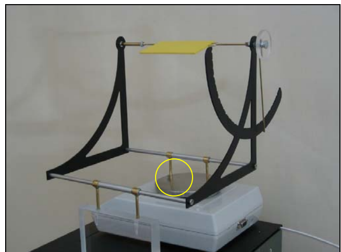
Support mit Messobjekt, Stütze mit Schraubfassung zur Fixierung an der Waage
