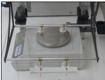
Die 20 mm Öffnung wird über die Stütze geschoben. Die schmale Öffnung hält den Messtisch.
