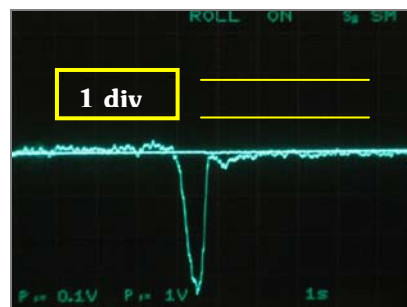
Typisches Signal: Grenzschicht an der Hinterkante
