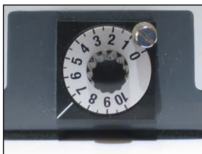
Einstellen für den Abgleich der Empfindlichkeit
