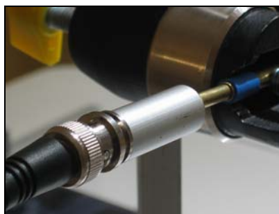
BNC Anschluss Sensor 5
